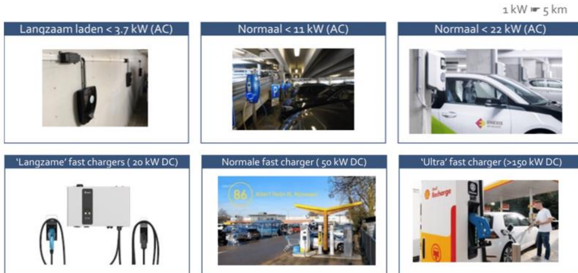
Figuur 3: Soorten laadpalen en bijbehorende vermogens
